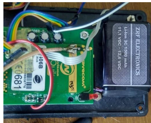
Gambar 7. Tata letak pemasangan baterai
