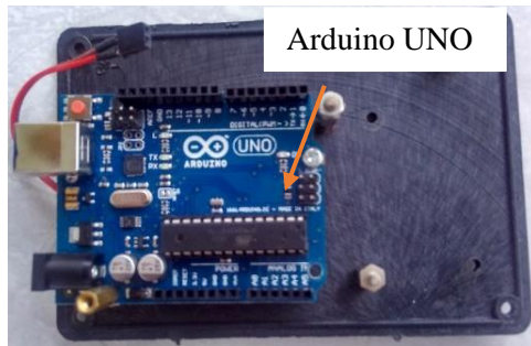
Gambar 3. Peletakan mikrokontroler arduino uno
